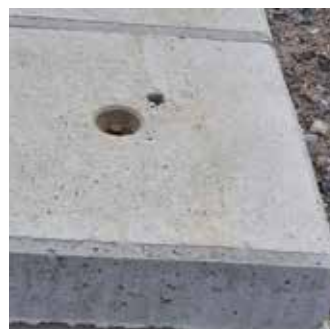
Tryckplatta för hörn till regnbädd/trädgrop. 500x500x120 mm till hörnor och 500x250x120 mm till stöd och sidelement.
